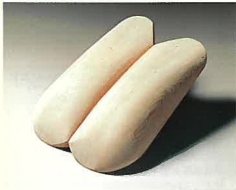
人体模型によるシート加圧治具 Sculptured Seat Loading Pad
