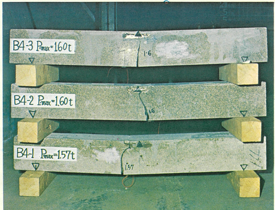
写真2: "MAT-X-2"の曲げ試験結果 photo2: the result of "MAT-X-2" bending test
