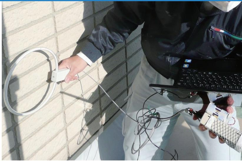
写真2 読み取り機により構造体内に設置したICタグ情報を検知している様子
