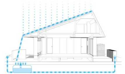
雨水集積・循環利用装置
